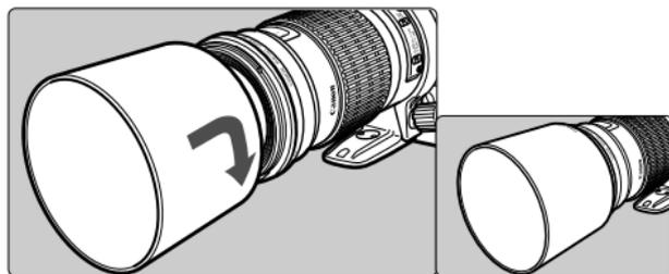
Бленда ET-78 II не допускает нежелательные блики и свет на линзы объектива, а также защищает объектив от попадания на поверхность линзы дождя, снега и пыли. Подсоедините и выровняйте бленду на креплении бленды в передней части объектива, затем поверните бленду, как это указано стрелкой, чтобы надежно закрепить ее. При хранении объектива можно закрепить бленду на объективе в обратной ориентации.
